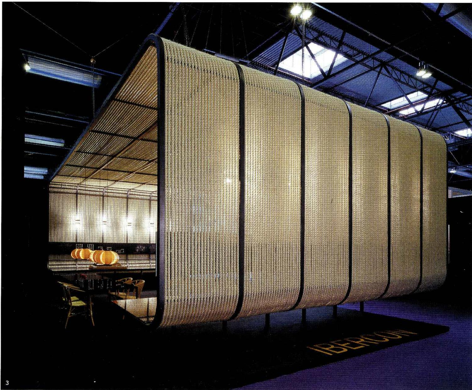
**1 y 2** El revestimiento de cuerdas que modula el stand conforma mobiliario (las superficies de exposición) y destaca la iluminación. **3** Vista general del espacio: el solado y el fondo son de moqueta negra y las paredes y el techo, de cuerdas sujetas por una estructura metálica.
